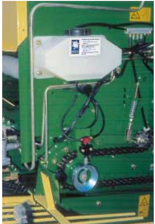
Bild 5: Durch die zentrale Kettenschmie- rung wird die Haltbarkeit der Antriebsket- ten erhöht und die Handhabung vereinfacht.
