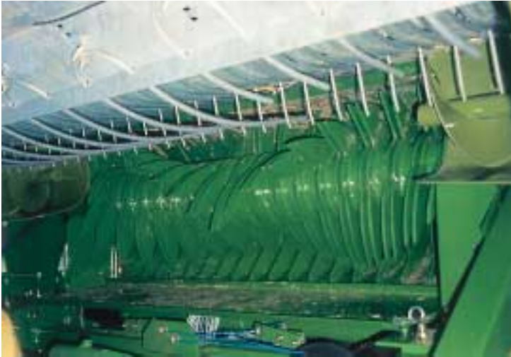
Bild 6: Der Schneid- und Förderrotor trans- portiert das Erntegut sicher in die Preßkammer
