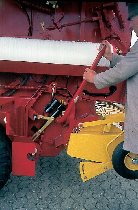
Bild 6: Bei Verstopfungen können der Schneid- und Förderrotor und die Pick-up manuell mit Spezialwerkzeug zurückgedreht werden.
