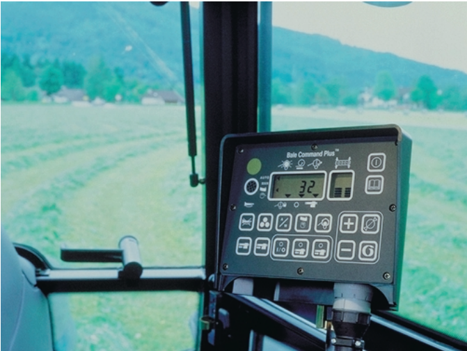
Bild 4: Die Fernbedienung „Bale Command Plus™“ ist in der Kabine im Sicht- und Bedienbereich beliebig installierbar.
