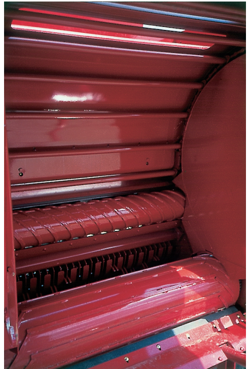
Bild 5: Die Preßkammer mit umlaufender Rollbodenkette
