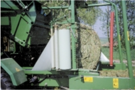
Bild 8: Sobald die Heckklappe geschlossen ist, kann während des neuerlichen Pressvorgangs der auf den Wickeltisch übergebene Rundballen mit Stretchfolie umwickelt werden.
