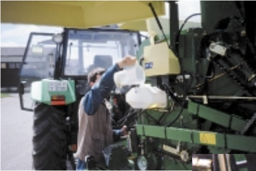
Bild 4: Große Schutzeinrichtungen erleichtern die Wartungsarbeiten, wie z.B. das Auffüllen des Vorratsbehälters von der zentralen Kettenschmierung.
