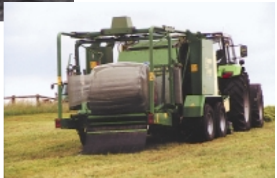
Bild 7: Die Rundballenübergabe von der Presskammer auf den Wickeltisch ist auch am Hang möglich.
