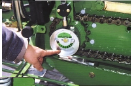
Bild 5: Die Ölmenge an der zentralen Kettenschmierung kann verändert werden.
