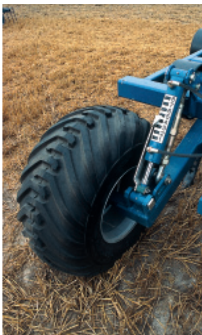
Bild 3: Tiefeneinstellung beim Vario erfolgt hydraulisch vom Fahrersitz
