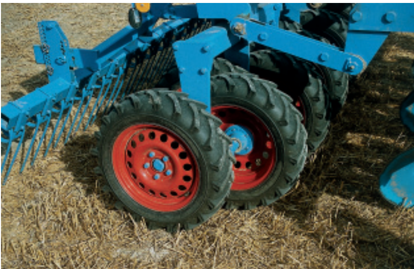
Bild 2: Nachläufer und Fahrwerk
