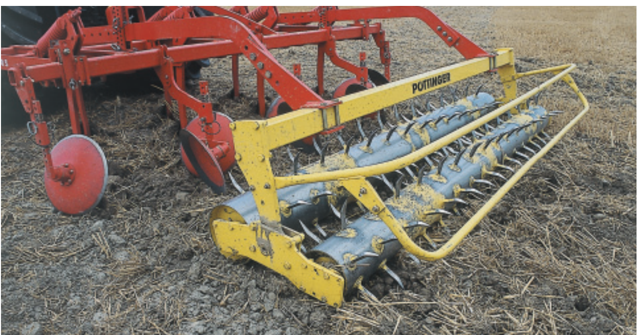
Bild 2: Pendelrotopack mit Schutzbügel und einstellbarem Walzenabstand
