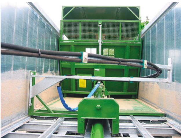
Bild 3, 4: Abschiebesystem, Schieber hinten, entladen
