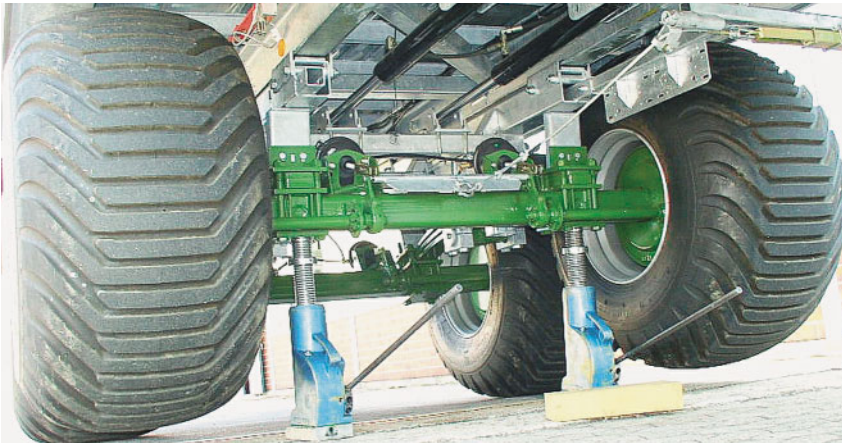
Bild 7: Vertikaler Versatz der Vorderachse um 70 mm Fahrwerk, Vorderachse angehoben
