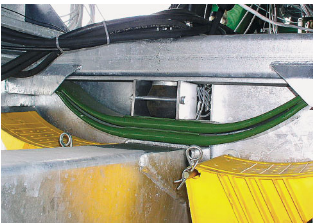
Bild 5: Deichselfederung zum Test blockiert
