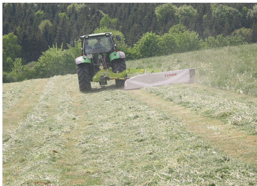
Bild 6: Die Hangversuche wurden auf einer Fläche mit bis zu 15° (30 %) Neigung durchgeführt.
