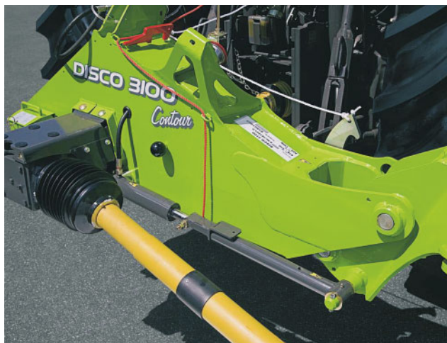
Bild 3: Über den quer liegenden, einfachwirkenden Entlastungszyinder erfolgt hydropneumatisch die Anpassung des Auflagedrucks.
