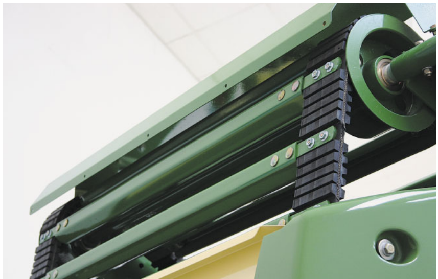
Bild 13: Die Gummigewebegurte senken den Geräuschpegel erheblich. Daneben benötigt die neue Gurtführung weniger Leistung, als die Stabkettenelevatoren.
