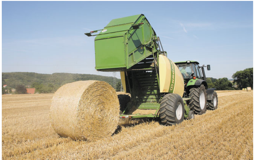
Bild 12: Das Auswerfen der Ballen klappte im Test durchweg problemlos.
