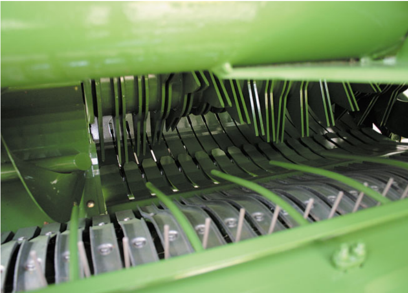
Bild 1: Aufgrund des größeren Einzugskanals sind im Mittel 20 % höhere Fahrgeschwindigkeiten möglich, als mit RoundPack und VarioPack.
