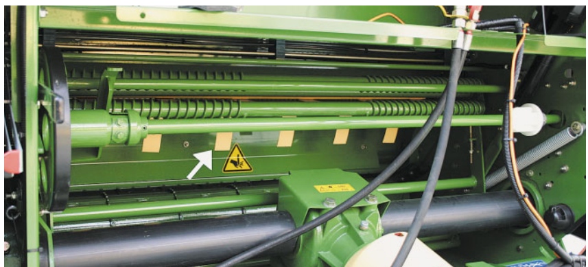
Bild 14: Kunststoffstreifen (siehe Pfeil) und auf die vordere Einzugswalze aufgeschweißte Flacheisen sorgen nun für einen sicheren Netzeinschub.
