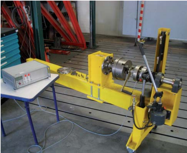
Bild 2 und 3: Messung der Haltekraft mittels DLG Drehmoment Prüfstand
