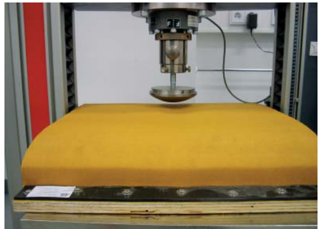
Bild 5: Messung der Verformbarkeit mit Kalotte
