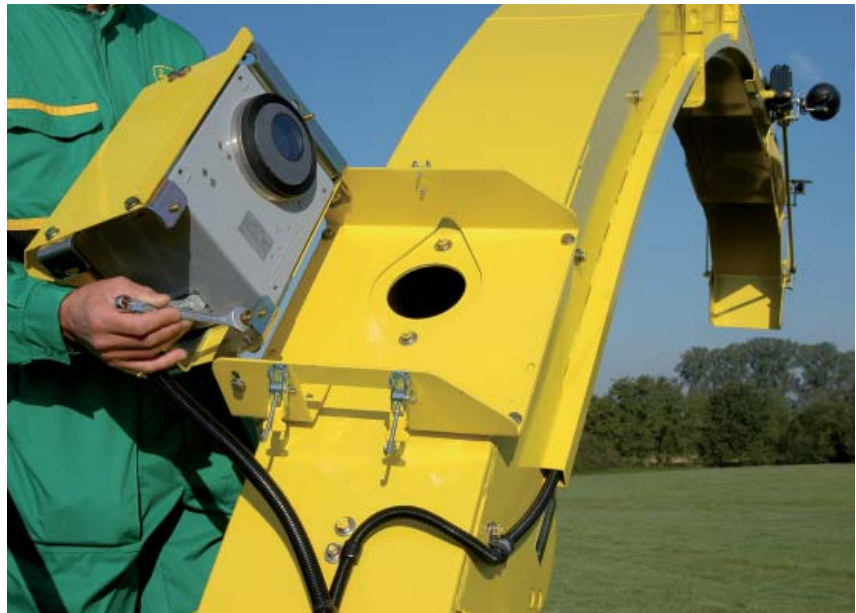
Bild 1: Sensor auf dem Auswurfkrümmer
