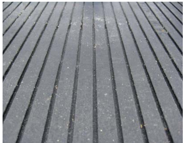
Bild 4: Rillen auf der Unterseite nach der Dauertrittbelastung
