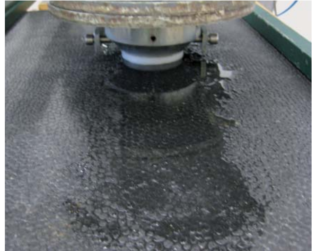
Bild 6: Messung der Rutschfestigkeit in nassem Zustand
