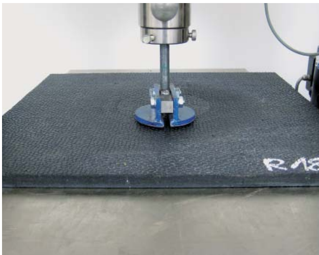
Bild 3: Messung der Verformbarkeit
