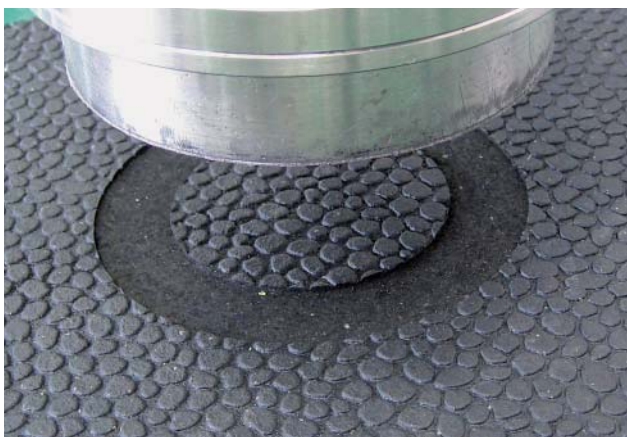
Bild 4: Testmuster nach dem Abriebtest
