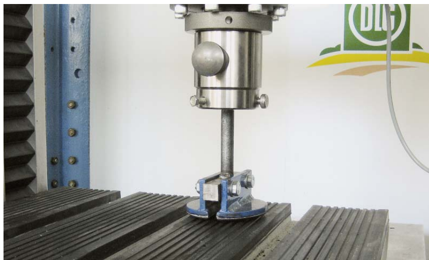
Bild 3: Messung der Verformbarkeit
