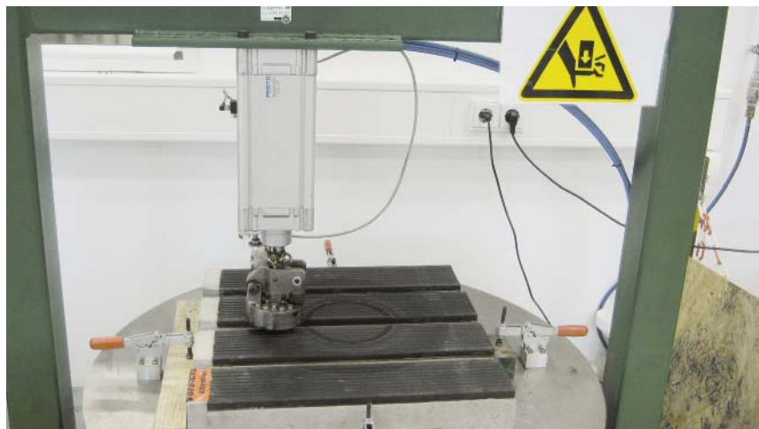
Bild 4: Prüfstand für Dauertrittbelastung
