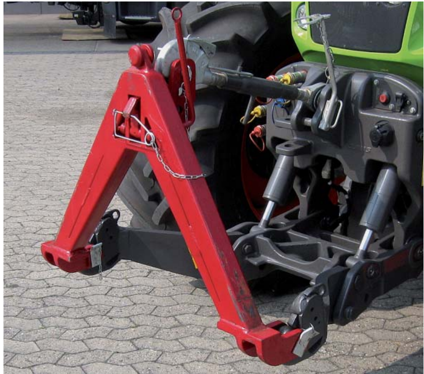
Bild 4: Anbau des Schlepperdreiecks in der Fronthydraulik
