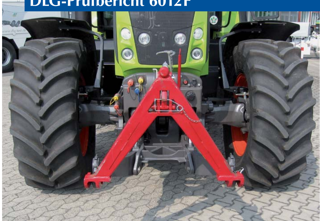
Bild 1: Schlepperdreieck Kategorie 2S im Frontkraftheber
