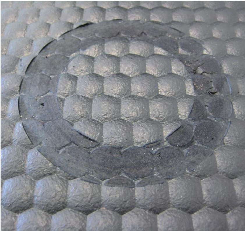
Bild 5: Testmuster nach dem Abriebtest
