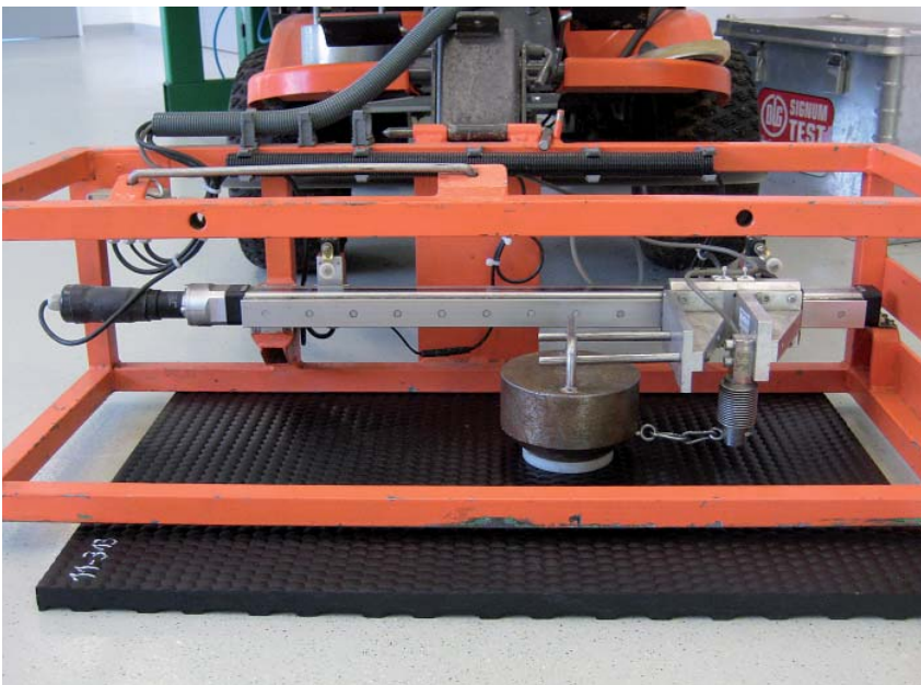
Bild 6: Messung der Rutschfestigkeit
