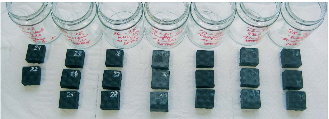
Bild 7: Prüfmuster nach Säurebeständigkeitstest
