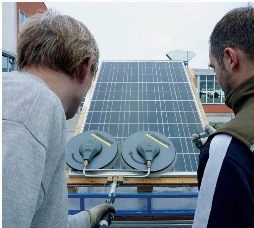
Bild 2: Modulreinigung beim Labortest
