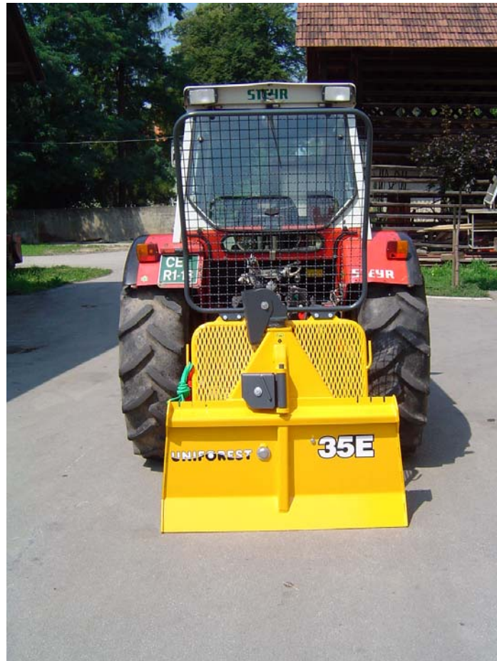
Abb. 2: Seilwinde am Traktor angebaut; sichtbar sind obere und untere Seileinlaufrollen
